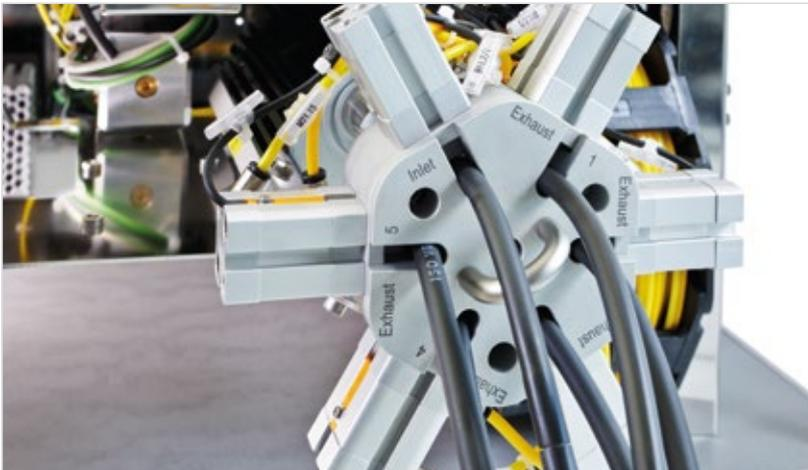
独立的 5 通道排气系统连接 5 组稀释系统。
