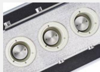
VITROCELL® 6/3, 6/4, 和 6/6 CF 染毒模组可连接电沉积系统，增加颗粒物沉积。
