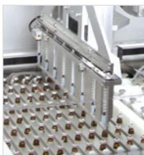
3 | 8个分别由8台步进电机控制的注射器排列成一排，注射器取样精确，重复性好。
