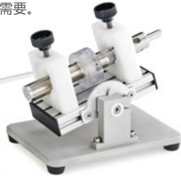
该仪器由点烟控制器、电子烟夹持器以及不同点烟装置组成
