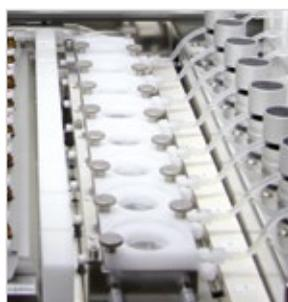
2 | 在 VITROCELL® 透皮试验仪内，有8个暴露室以及热水循环系统（32-34 °C）。磁力搅动器以不同频率搅动底液。
