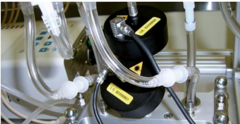
安装在染毒模组气溶胶入口和出口的 VITROCELL® 光度计。
