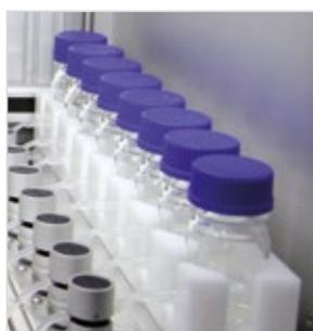
1 | 底液储存在玻璃瓶内，通过重力法或者注射器进入 VITROCELL® 透皮试验仪。
